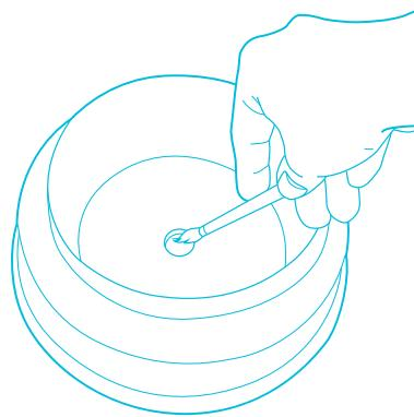
Pour un nettoyage en profondeur, verser un mélange 50/50 de vinaigre et d'eau dans le réservoir et laisser agir pendant cinq minutes. Nettoyez les parois du réservoir, le socle et la membrane à ultrasons avec une brosse à poils doux (non incluse) et rincez. Ne jamais toucher la membrane à ultrasons avec les doigts, car les huiles naturelles de la peau peuvent l'endommager.
