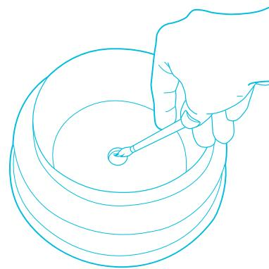
Para una limpieza a fondo, vierta una mezcla 50/50 de vinagre y agua en el depósito, deje que se impregne durante cinco minutos. Cepille las paredes del depósito, la base y la membrana ultrasónica con un cepillo de cerdas blandas (no incluido) y enjuague. Nunca toque la membrana ultrasónica con los dedos ya que los aceites naturales de la piel pueden dañarla.
